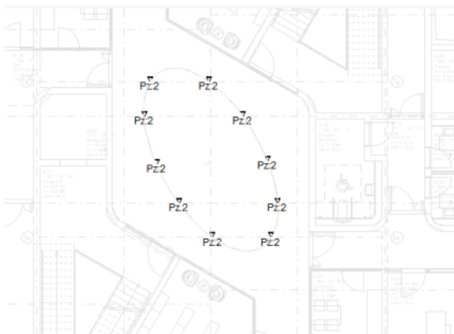
Abhängungspunkte Foyer Stirnseiten Deckenausschnitt 1. und 2. Obergeschoss
