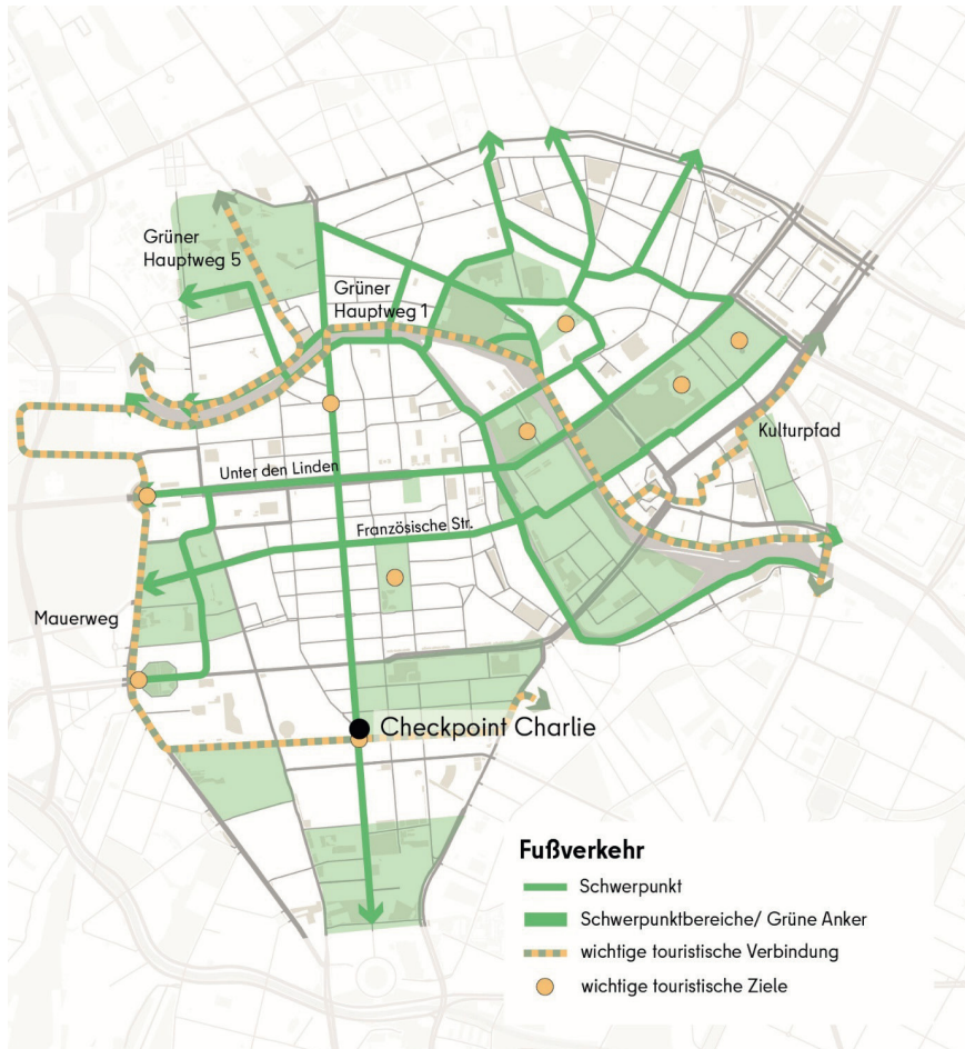
Abb. 78 Schwerpunktnetz Fußverkehr (Quelle: Büro Happold, 2025)
