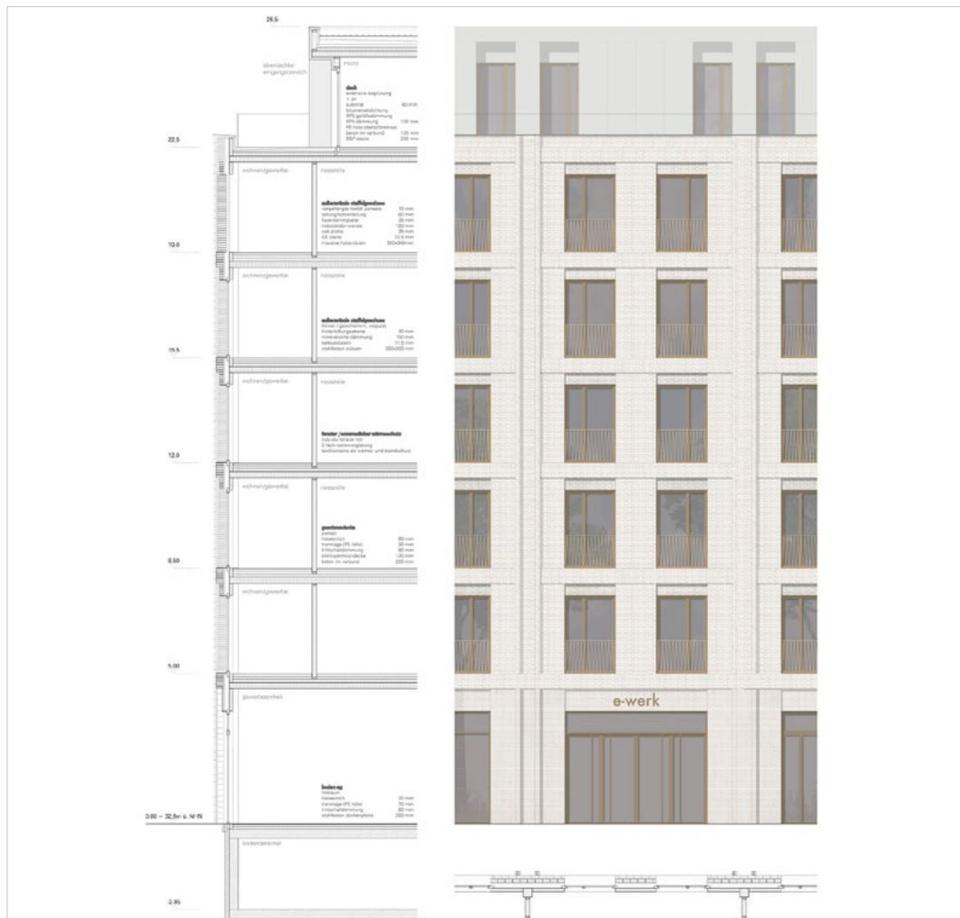
▲ Fassadendetail, Ansicht und Schnitt (TN)
