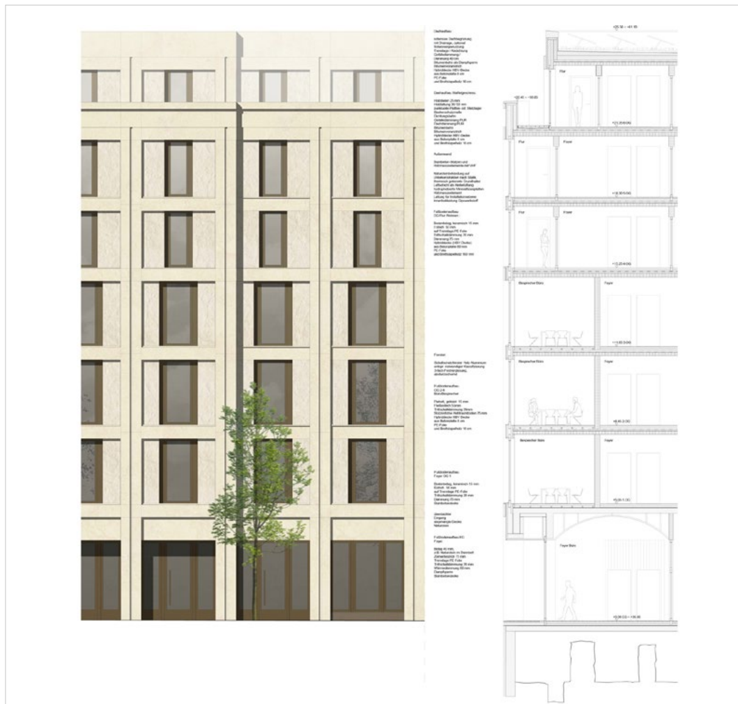
▲ Fassadendetail, Ansicht und Schnitt (TN)
