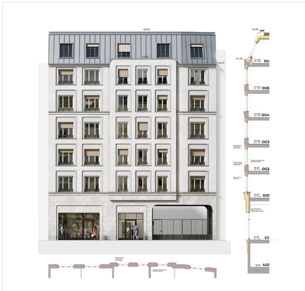
▲ Fassadendetail, Ansicht und Schnitt (TN)
