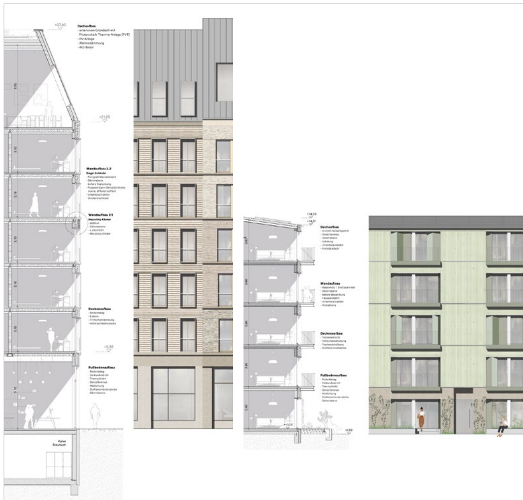
▲ Fassadendetail, Ansicht und Schnitt (TN)
