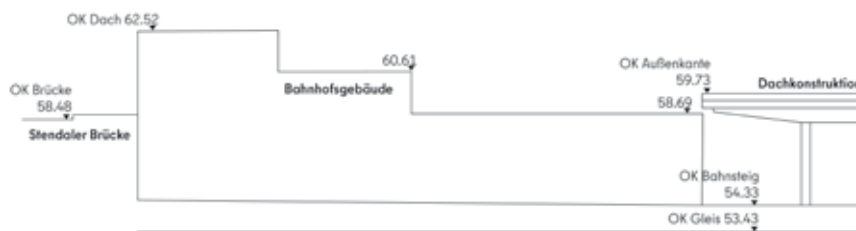
Abb. 43 Schematische Darstellung der Bezugshöhen (Stendaler Brücke, Bahnhofsgebäude, Dachkonstruktion)
