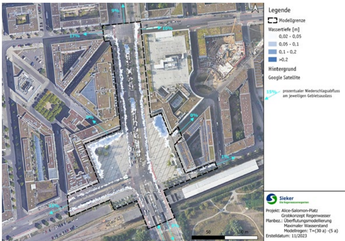
Abb. 16 Maximaler Wasserstand im Wettbewerbsgebiet bei einem Modellregen T=(30a)-(5a)
