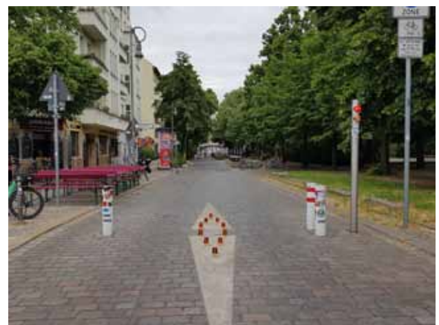
Foto 4 : Zufahrt an der Südwestseite des Lausitzer Platzes mit versenkbaren Pollern
