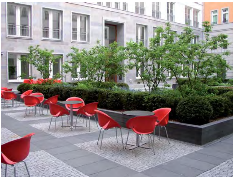
Abb. 62: Nutzung gebäudenaher Flächen durch intensive Dachbegrünung auf einem unterbauten Innenhof
