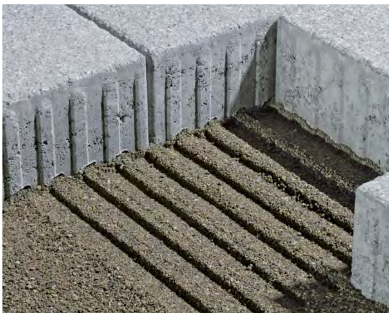
Abb. 47: Innovative Baumaterialien tragen zur Langlebigkeit einer Außenanlage bei: Rundumverzahnung und die gekerbte Unterseite machen diesen Pflasterstein bei stark beanspruchten Flächenbelägen gegen horizontale Verschiebungen stabil.
