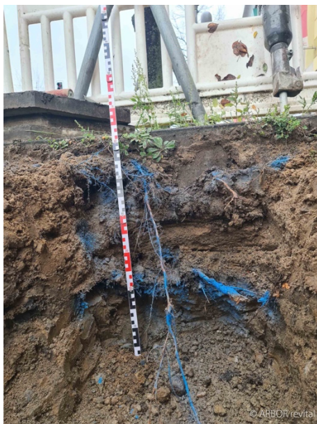
Abb. 38: Bodenprofil: Bettung - Bodengemisch, Unterbau, grobkörniges, durchwurzeltes Substrat, extrem verdichteter Boden mit hohem Lehmanteil. Aufnahme: 08.11.2023
