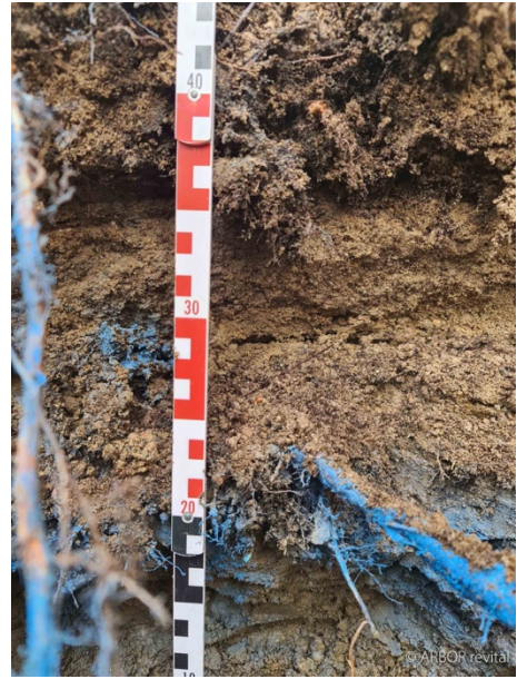
Abb. 37: stark verdichtete Schotterschicht ca. 20 cm Stärke in ca. 15 cm Tiefe, Aufnahme: 08.11.2023
