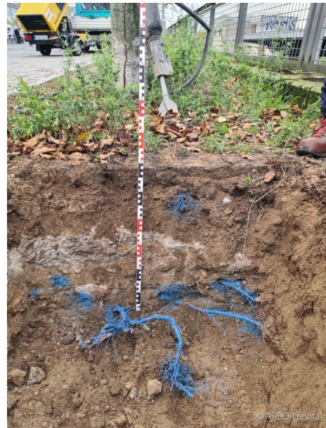
Abb. 40: Bodenprofil mit Betonrückenstütze und starker Auswurzelung in 50 cm Tiefe, Aufnahme: 08.11.2023
