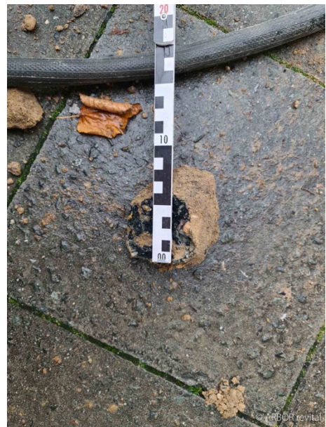
Abb. 35: Bitumenklumpen aus ca. 20 cm Tiefe, Aufnahme: 08.11.2023
