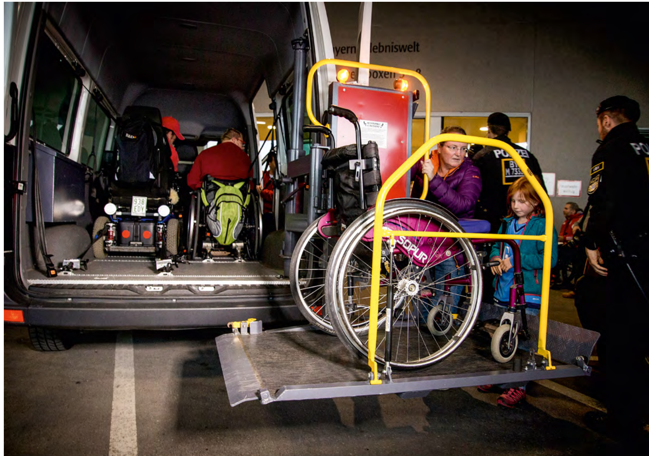
Hebebühne für Rollstuhlnutzer an einem Van eines Behindertenfahrdienstes.
